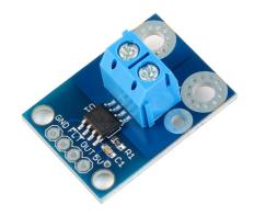
Questa scheda utilizza il sensore ACS711ELCTR-12B-T della Allegro, sensore di corrente basato su effetto Hall che offre un percorso di corrente a bassa impedenza ( $\sim$ 1.2m $\Omega$ ).
